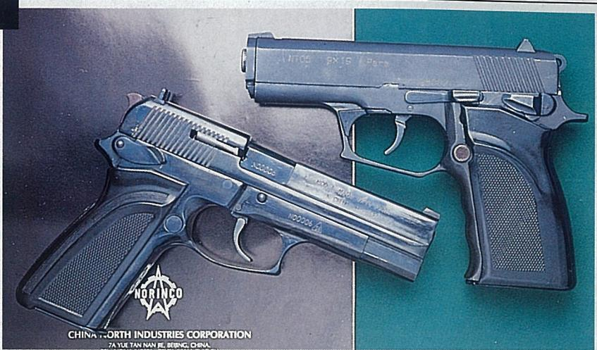
►アメリカ市場を失った中国にとって、ヨーロッパ市場は重要だ。今回のIWA'95には新しい大型ピストルが2丁展示された。いずれもプロトタイプらしい。1つはガス・ロックを組み込んだNT-05(写真上)で、もう1つは従来のT-88SPのフレームを流用し、バレルのロッキングをエジェクション・ポートに改めたNT-02(写真下)である。いずれのモデルもダブル・アクション・トリガーを備えている。
